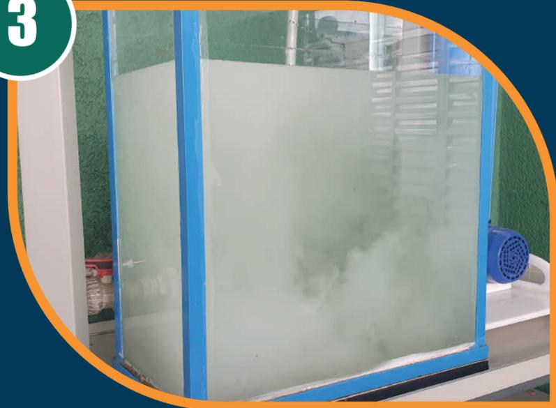
Ao se espalharem a água fica com um aspecto leitoso, devido a alta concentração de gases na água, aspecto esse que desaparecerá após um longo período.
