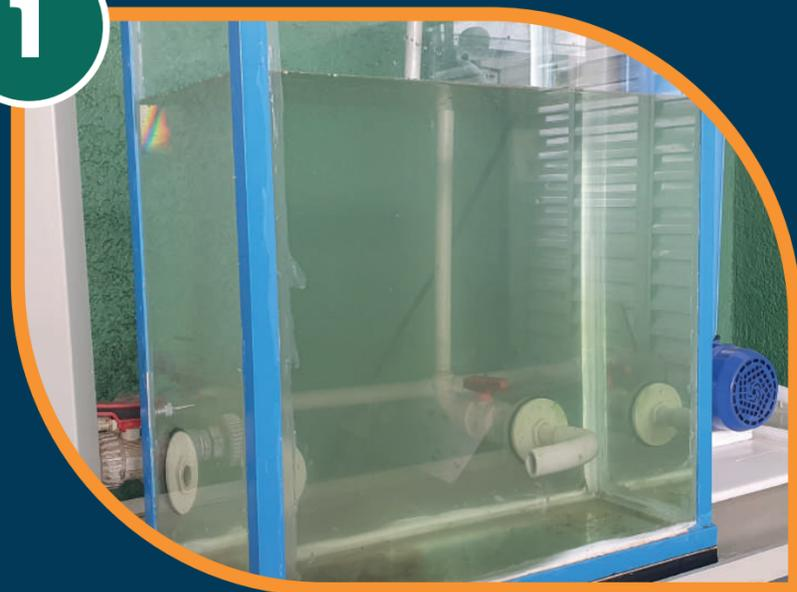
O gerador de microbolhas deve ser instalado na parte inferior do tanque, pois quanto mais tempo o gás ficar em contato com a água ou efluente maior será a quantidade dissolvida. Com seu posicionamento na parte inferior, outro benefício será o fato das microbolhas, devido a pressão que são expelidas, agitarem o fundo do tanque.
