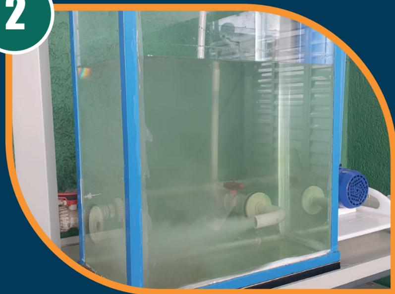
As microbolhas, ao serem expelidas, se espalham no tanque de maneira uniforme devido ao movimento browniano, que faz com que as próprias microbolhas se afastem, agitando o fundo do tanque e levando para cima pequenas partículas de sujeira.
